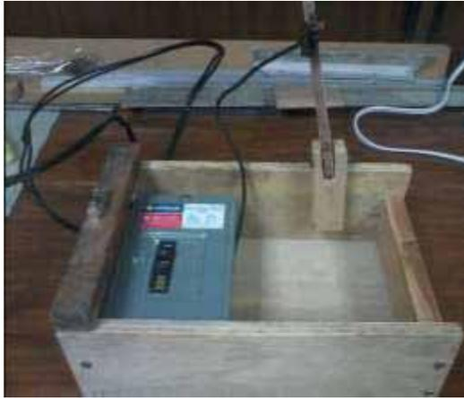
Figura 8. Soldador de termopares
